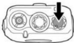
Поверните **выключатель питания** по часовой стрелке, чтобы включить радиостанцию.
