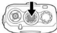
Поверните **переключатель каналов**, чтобы выбрать желаемый канал. Поворот по часовой стрелке увеличивает номер канала; против часовой стрелки - уменьшает. Если канал не запрограммирован, его не удастся использовать. Когда выбран незапрограммированный канал, световой индикатор мигает попеременно красным и оранжевым, и раздается звуковой сигнал.
